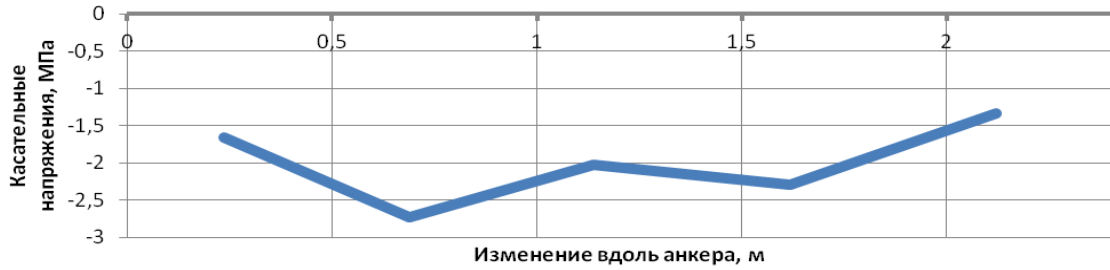
Рисунок 2.51 – Распределение касательных напряжений вдоль анкера № 2:
